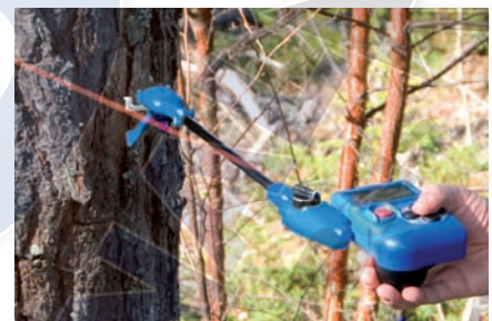
Le compas forestier à faisceau laser Digitech Pro One.
