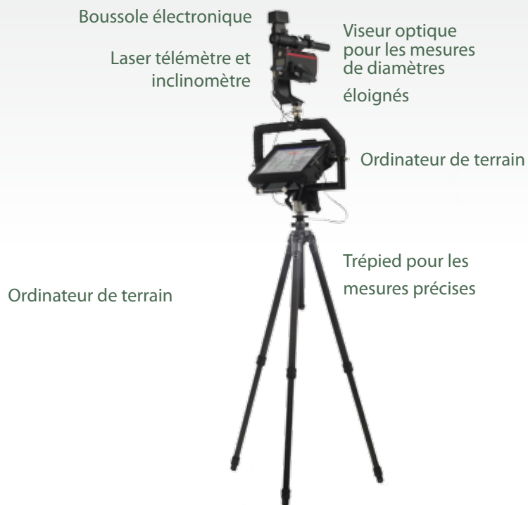
Mesures de diamètres en hauteur avec la jumelle brevetée par IFER
